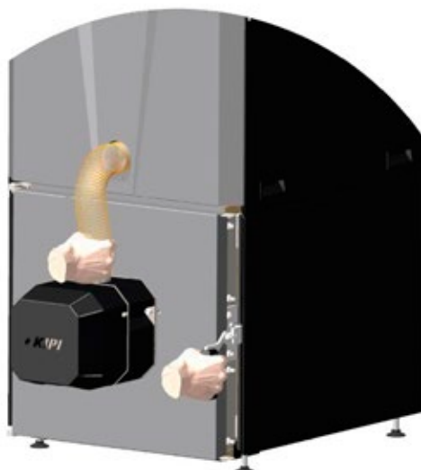
Rysunek 30 - Sprawdzenie zamocowania rury spiro i szczelności drzwi kotła
