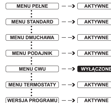
Rys.4. Sterowanie kotłem podajnikowym z jednym obiegiem grzewczym sterowanym termostatem pokojowym.
