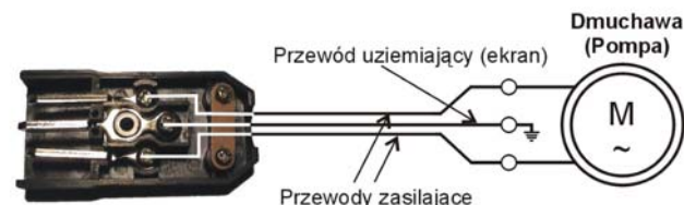
Rys. Podłączenie przewodów od dmuchawy/pompy do wtyczki.
